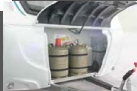
Gasflaschenkasten für 2 x 11 kg mit Boden aus verrottungssicherem, stabilem Aluminium-Riffelblech
