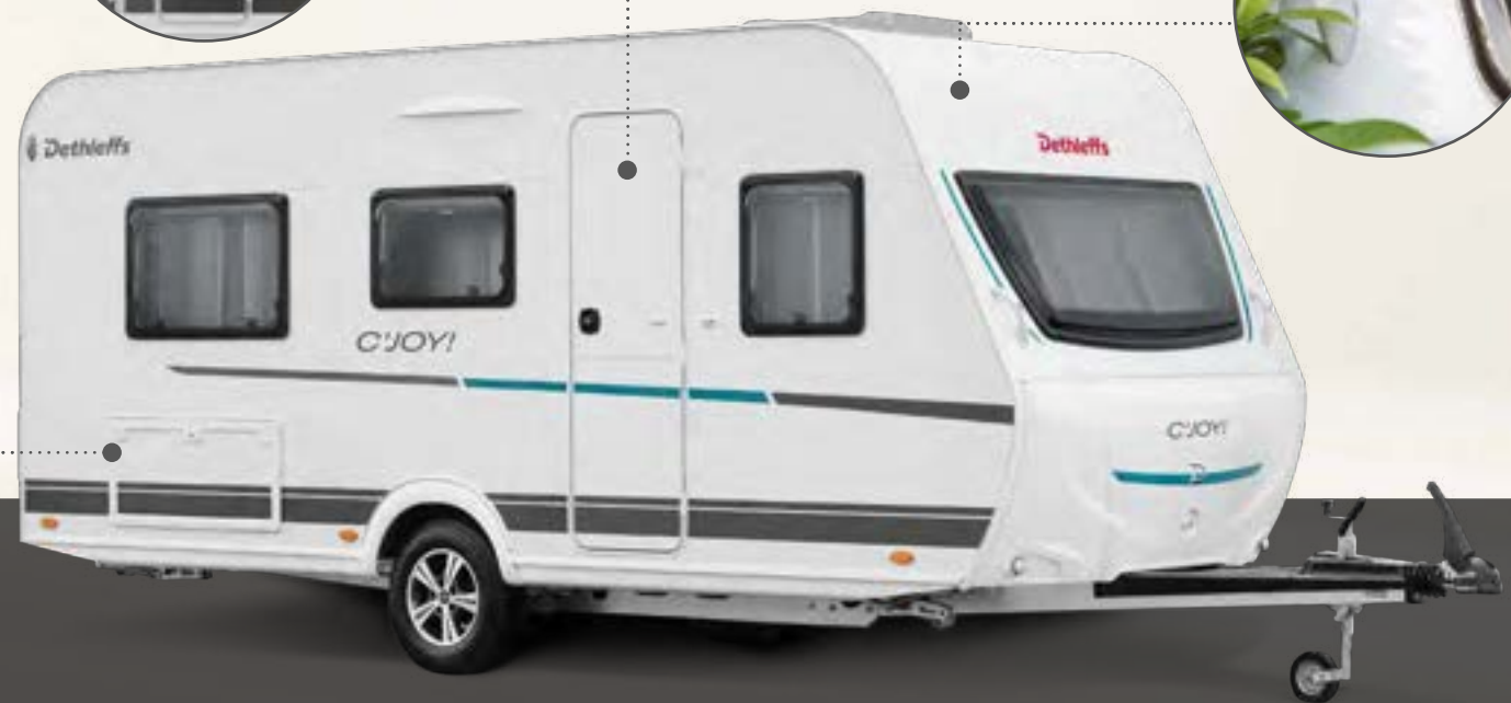
Bug, Dach und Heck aus widerstandsfähigem GFK
